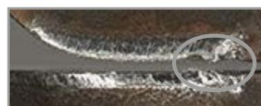
Wykruszenia krawędzi skrawającej
